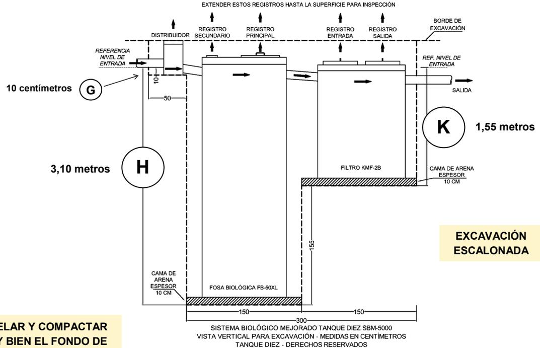
**NIVELAR Y COMPACTAR MUY BIEN EL FONDO DE LA EXCAVACIÓN**
