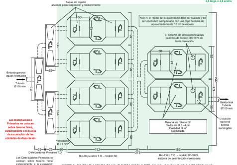
SISTEMA DE TRATAMIENTO TANQUE DIEZ MODELO PTB-0X100 - CAUDAL DIARIO A TRATAR 10 M<sup>3</sup> VISTA SUPERIOR DE LAS UNIDADES DE TRATAMIENTO - MEDIDAS EN CENTÍMETROS TANQUE DIEZ - DERECHOS RESERVADOS
