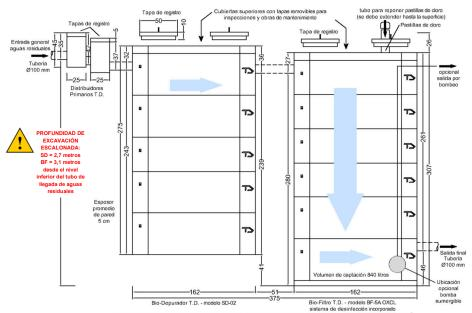
SISTEMA DE TRATAMIENTO TANQUE DIEZ MODELO PTB-OX100 - CAUDAL DIARIO A TRÁTAR 10 M<sup>2</sup> VISTA VERTICAL DE LAS UNIDADES DE TRATAMIENTO - MEDIDAS EN CENTÍMETROS TANQUE DIEZ - DERECHOS RESERVADOS
