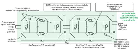
SISTEMA DE TRATAMIENTO TANQUE DIEZ MODELO PTB-AQ20 - CAUDAL DIARIO A TRATAR 2 M<sup>2</sup> VISTA SUPERIOR DE LAS UNIDADES DE TRATAMIENTO - MEDIDAS EN CENTÍMETROS TANQUE DIEZ - DERECHOS RESERVADOS
