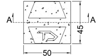
Tapa normal en concreto para Caja Multiuso T.D.
