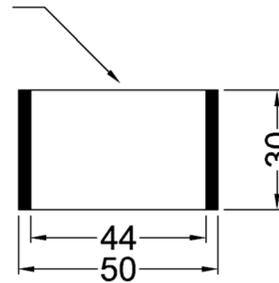
Anillo de extensión CM-EXT30 para Caja Multiuso T.D. y usos varios sección vertical - medidas en cm
