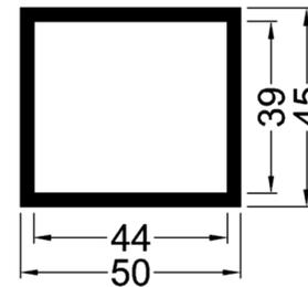
Anillo de extensión CM-EXT30 para Caja Multiuso T.D. y usos varios sección horizontal - medidas en cm
